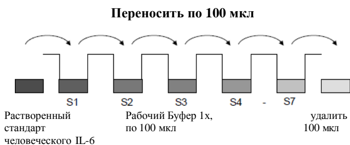
Рисунок 7. Приготовление серийных разведений Стандарта ПЛ-6 в лунках планшета:
